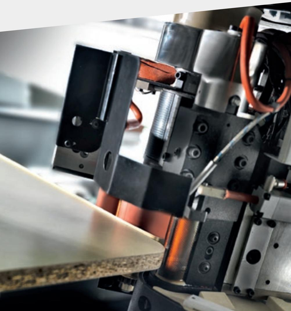
Máxima qualidade de pressão de borda durante a fase de colagem em painéis moldados, graças ao sistema de pressão da borda equipado com dois rolos.
